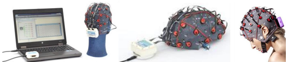
Fig. 1 Sistema wireless ed indossabile di registrazione EEG.
